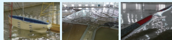
船舶系靠泊试验 科伦坡港口城局部整体模型 刚果共和国黑角矿业港项目模型
