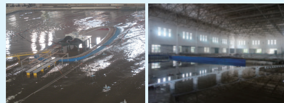
港珠澳大桥人工岛波浪整体模型试验 马代Male大桥波浪整体模型试验
