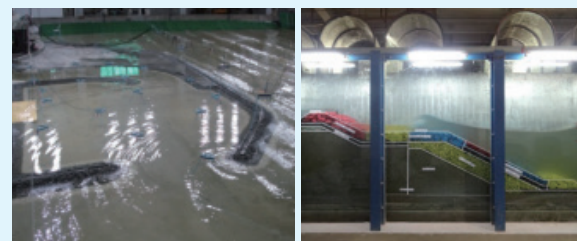
阳江核电站波浪传播变形 防波堤断面试验
